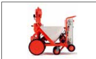
Оборудование для механизированного нанесения штукатурной смеси (штукатурная станция, растворонасос со шлангом, смеситель, компрессор, распылитель и т.д.)
